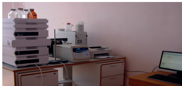
1.1-rasm. Yuqori samarali suyuqlik xromatografiyasining qurilmasi.
