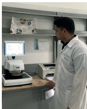
1-rasm: Ozuqa tarkibidagi protein universal infraqizil nurli ekspress analizator Perten DA7250 apparatida tekshirish
