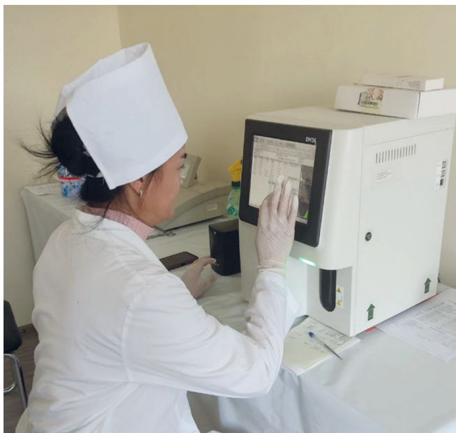
1-rasm. Eritrotsitlar soni, gemoglobin miqdori, gematokrit ko'rsatkichini avtomatik gematologik analizator "Mindray BC-5000" da aniqlash jarayoni
